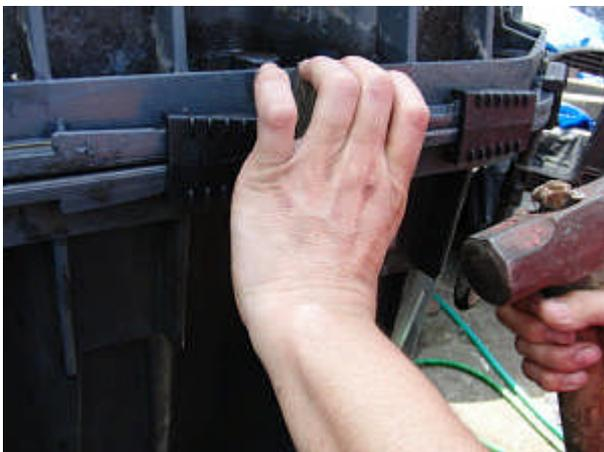
タンク上部側を下部側の上に重ねます。このときパッキン、ズレ止め防止の部材が上部側の溝、穴に入るように注意してください。タンクを重ねたらクサビをつけて締めていきます。
