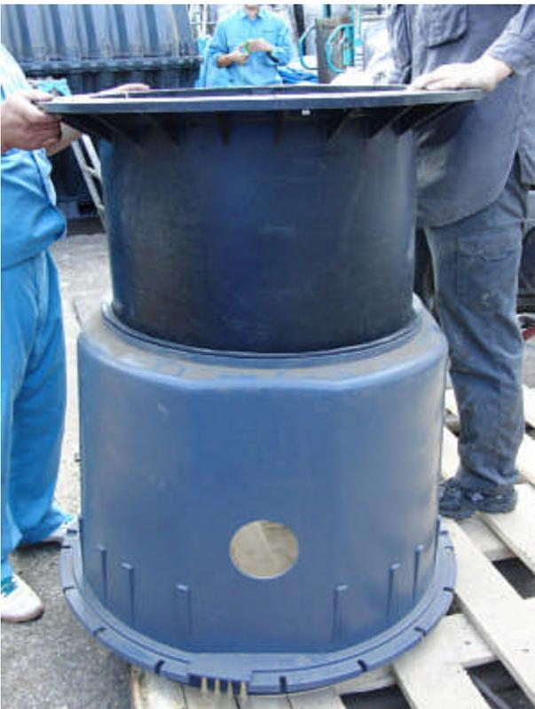
立ち上がり部品に高さ調整パーツを差し込み、タンク上部につけて高さ調整を行います。これでタンクの組み立て完了です。
